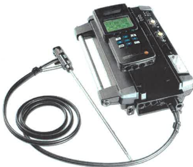
Fig. 4.3. Analizorul de gaze multifuncțional TESTO 300 XXL
