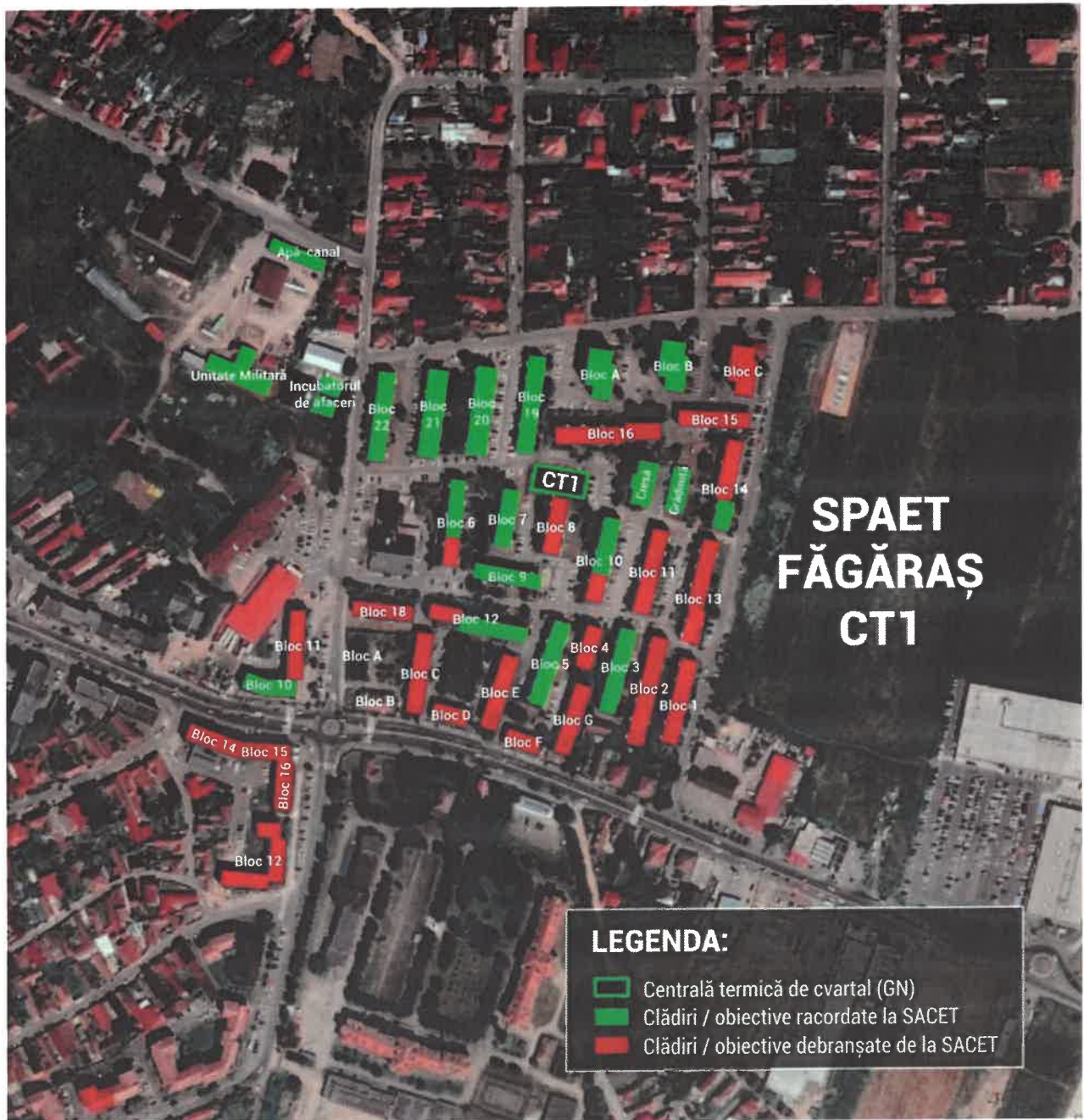
Fig. 2.4. SACET Făgăraș – CT 1: imobile racordate în prezent (2024) la sistemul centralizat, comparativ cu situația inițială (2000)
