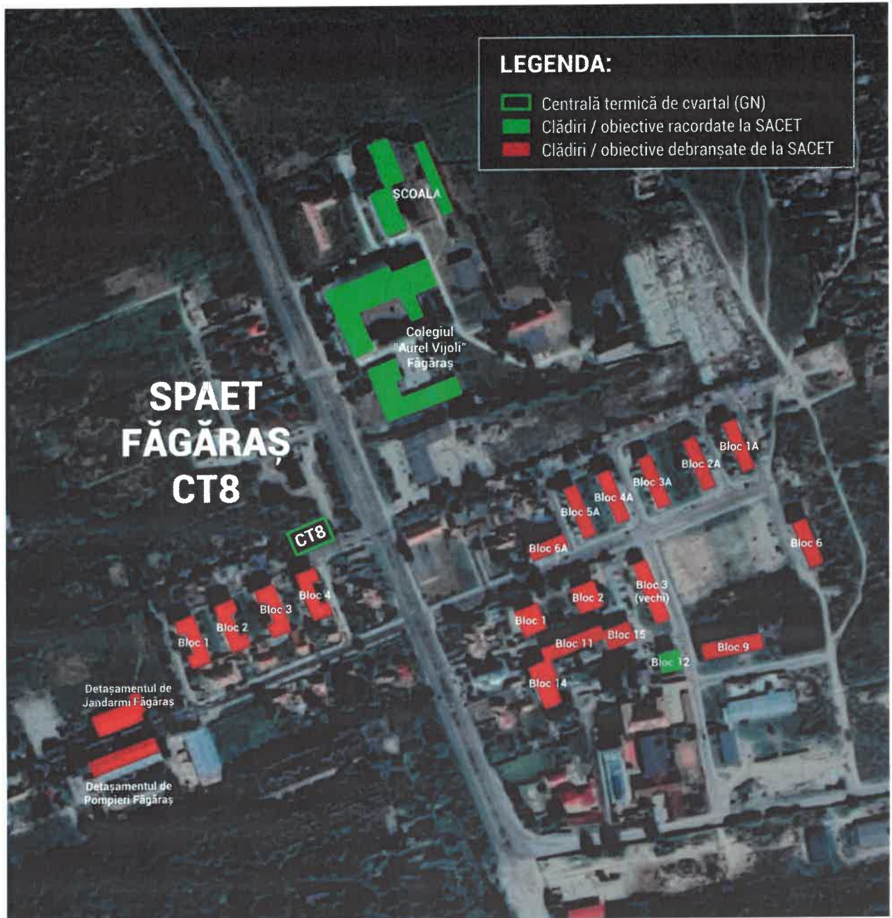
Fig. 2.10. SACET Făgăraș – CT 8: imobile racordate în prezent (2024) la sistemul centralizat, comparativ cu situația inițială (2000)
