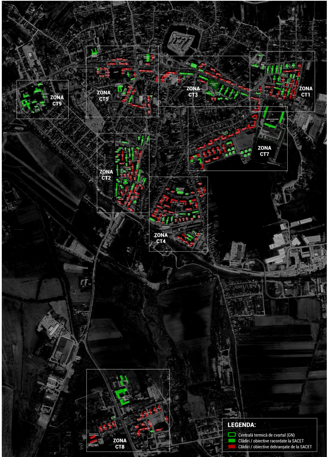
Fig. 2.3. SACET Făgăraș – imobile racordate în prezent (2024) la sistemul centralizat, comparativ cu situația inițială (2000)
