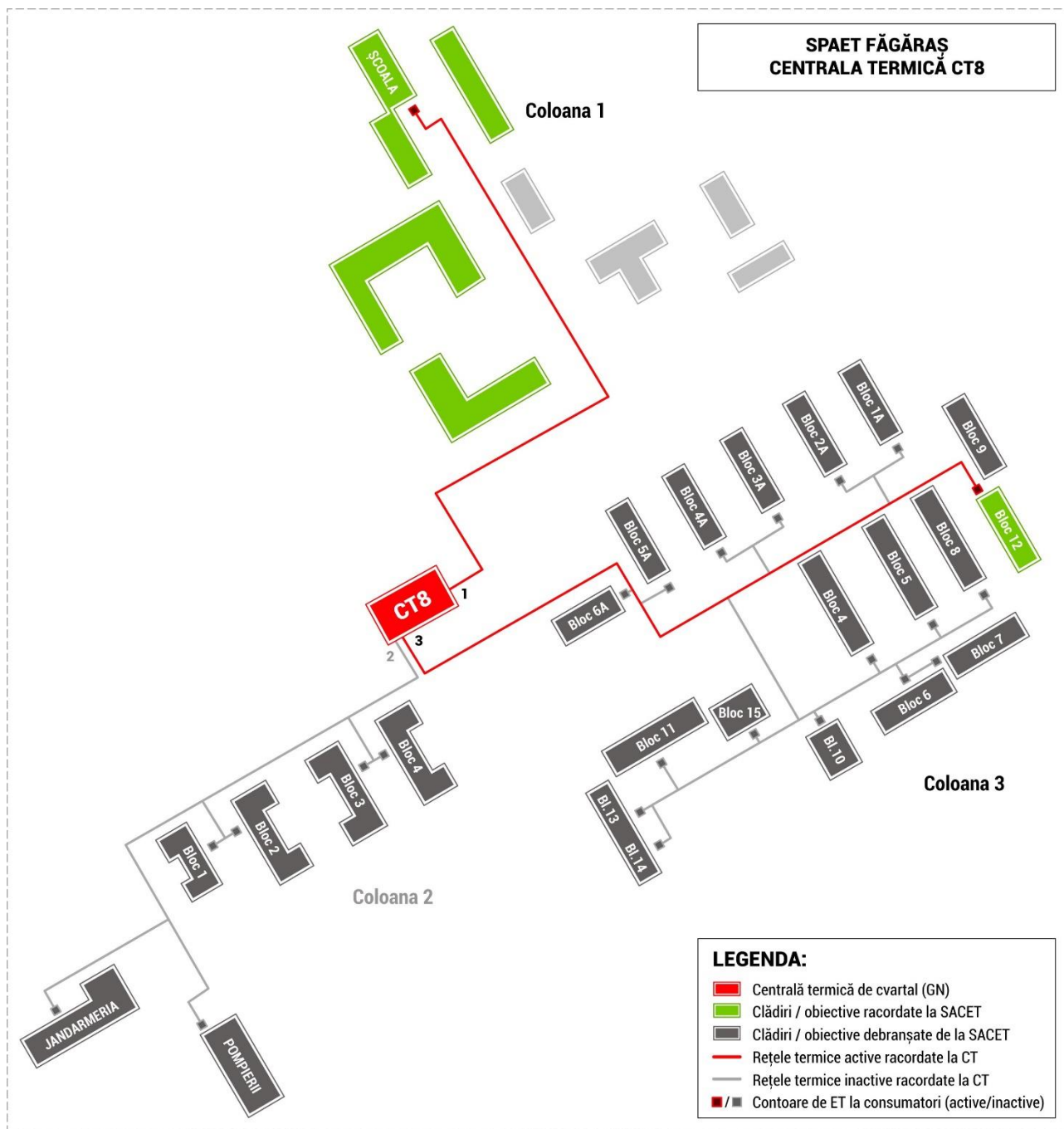
Fig. 1.15. CT 8 - Schema rețelei de distribuție racordate, cu indicarea consumatorilor bransați
